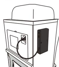
ウォーターサーバー側面に、非常用電源ユニットを貼り付けます。
