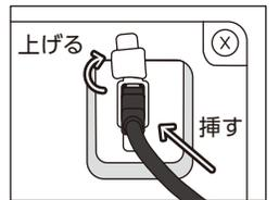
ウォーターサーバー背面の USB ポートのカバーを上げ、非常用電源ユニットの USB ケーブルを接続します。
