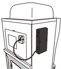
ウォーターサーバー側面に、非常用電源ユニットを貼り付けます。
